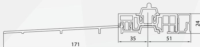
Möglichkeit der Montage auf Fertigboden
