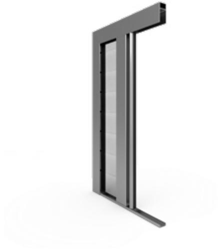
Ein spezielles plissiertes Netz, das beim Schließen wie eine Ziehharmonika gefaltet wird und sich platzsparend in das Seitenprofil einzieht. Konzipiert für den Einbau an Terrassentüren und Balkonnischen. Breite 21 mm. Kann bis zu 4 m lang sein.
