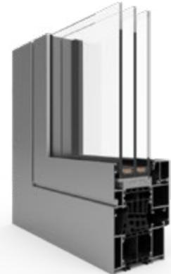
Das Profil ist innen und außen aus Aluminium gefertigt. Im mittleren Teil befindet sich eine thermische Trennwand, die die Wärmedämmleistung der Profile deutlich erhöht.
