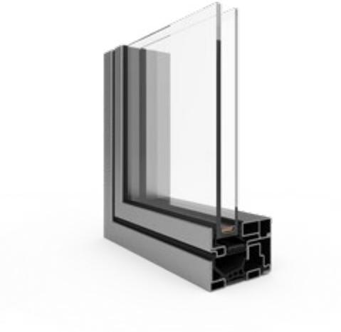
Das Profil ist innen und außen aus Stahl gefertigt. Im mittleren Teil befindet sich eine thermische Trennwand, die die Wärmedämmleistung der Profile deutlich erhöht.
