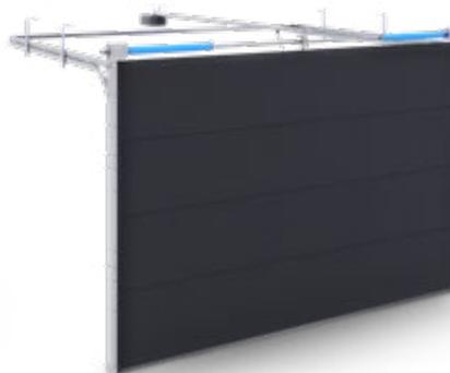
Drehfedern werden für etwas größere Torelemente empfohlen. Dieses System ist im Stande eine höhere Last zu heben bzw. zu öffnen. Die Montage mit Drehfedern von vorne ist nur möglich, wenn der Sturz min. 200 mm hoch ist. Die maximale Last beträgt 195 kg.
